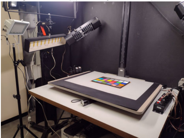
Figura 26: Setup para fotografia Multiespectral
